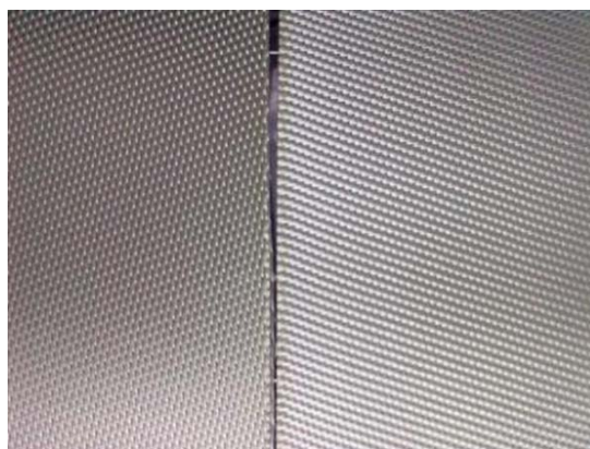
Рис. 1. Pt-содержащий катализатор ИК-12-С111, синтезированный методом ИПТ
