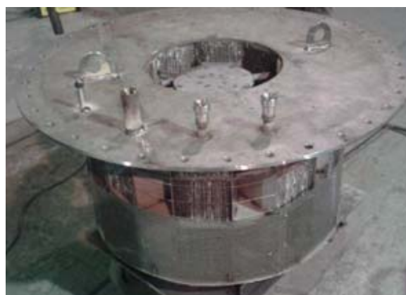
Рис. 3. Радиальный слой катализатора из призматических каталитических картриджей
