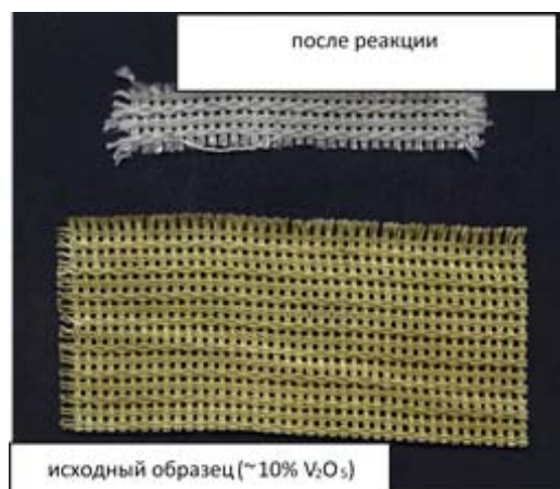
Рис. 1. Внешний вид ванадиевого катализатора на стекловолокнистом носителе
