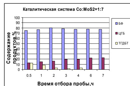
Рис. 3. Состав продуктов гидрогенолиза ДБТ для системы \text{Co}:\text{MoS}_2
